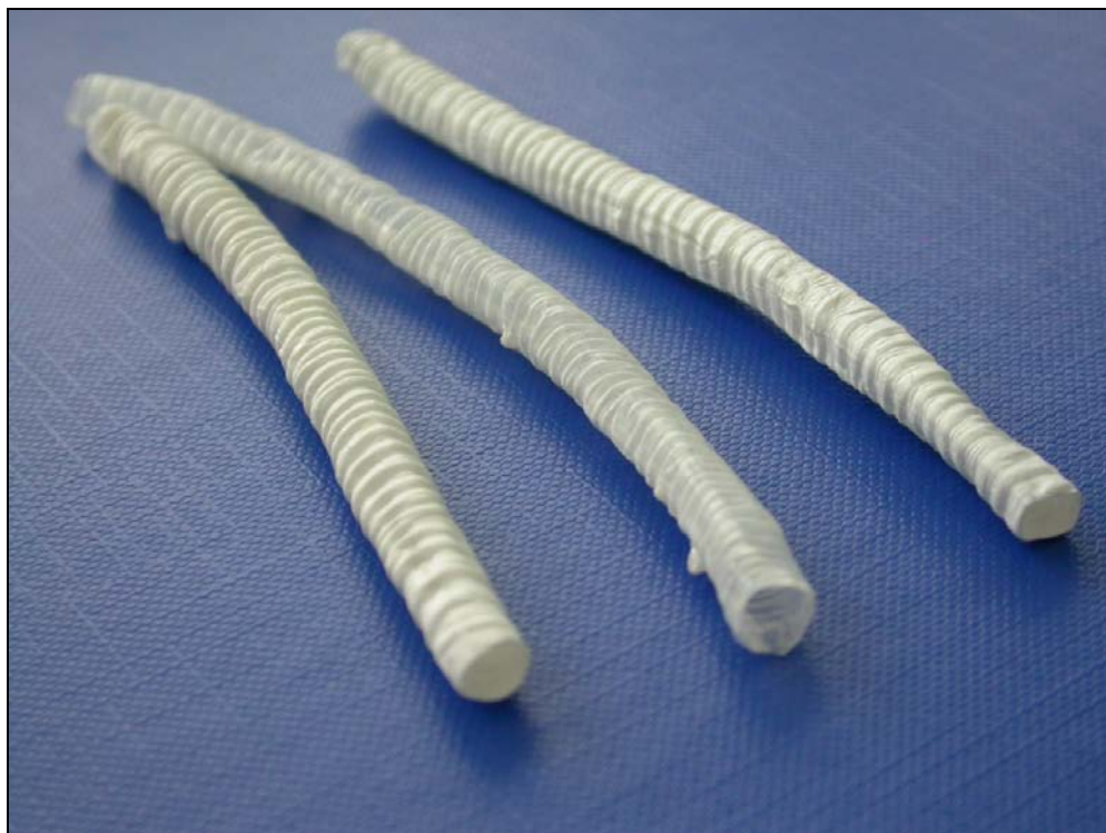
Рис. 2.8. Прототипы полностью резорбируемых эндопротезов из полигидроксibuтирата (фото Т. Г. Воловой)
